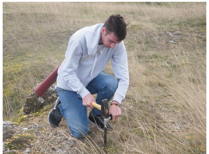
3.4. ábra A pont állandósítása fémcsővel
