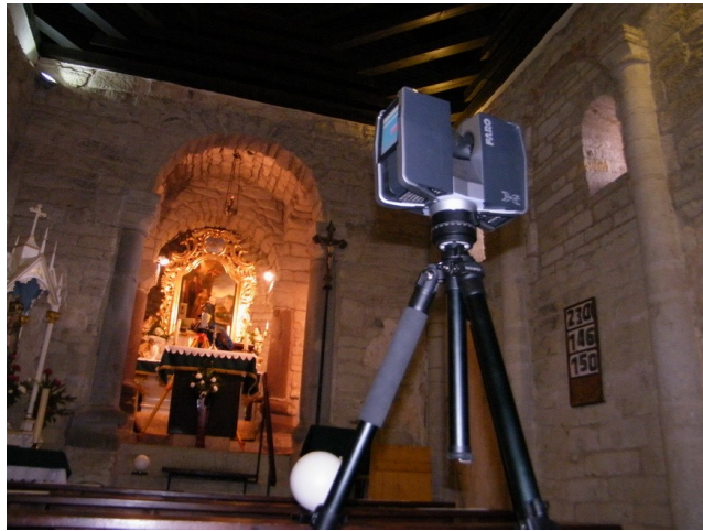
2. ábra. Lézerszkenneres mérés a templombelsőben
