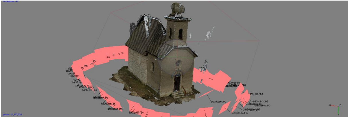
11.1.2 ábra Agisoft PhotoScan által készített pontfelhő
