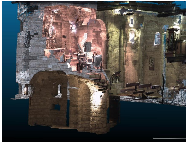
13.1.3 ábra Metszetek a szentélyről és az altemplomról különböző szemszögekből
