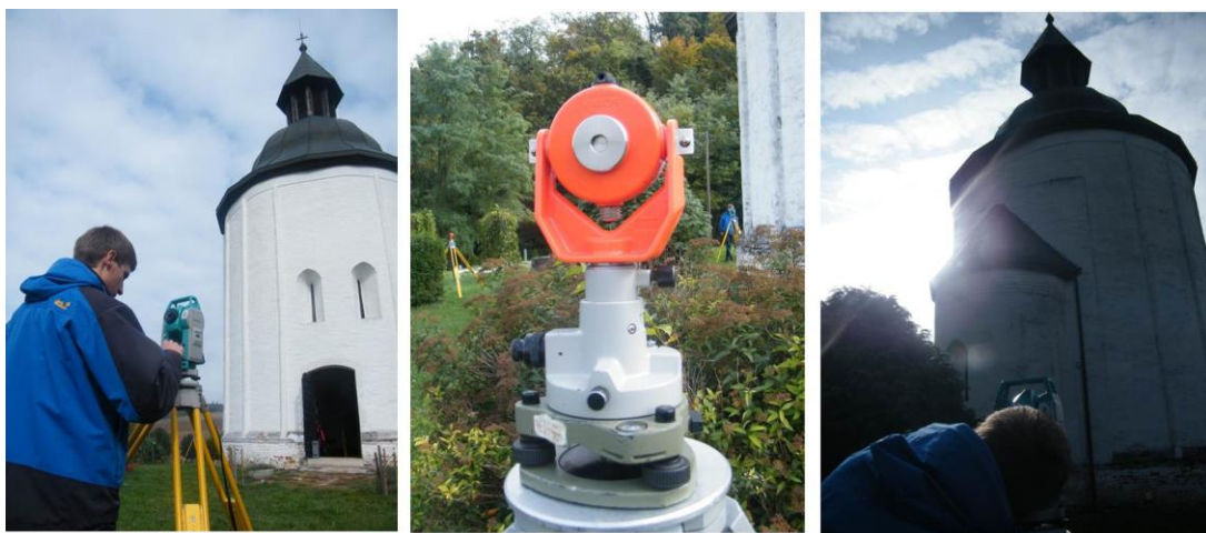
7.3. ábra. Mérés a Sokkia SET 230RK mérőállomással az épület körül
