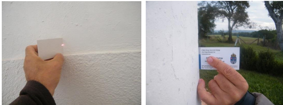
3.3. ábra. Távmérés prizmanélküli módon a falhoz illesztett, és az irányvonalra merőleges tartott kártyára
